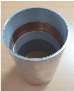
Revêtement interne Al2024+Cu pur sur tube inox diamètre 95 mm
