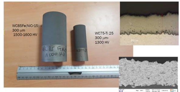
Dépôt de carbures pour une application anti-usure (source: ICAR-CM2T)
