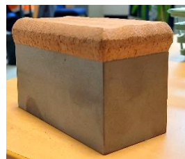
← Revêtements épais de laiton et cuivre sur un substrat aluminium
