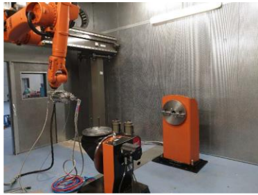
Robot KUKA avec pistolet de projection Impact 5/11 et les vireurs et positionneurs dans la cabine de projection
