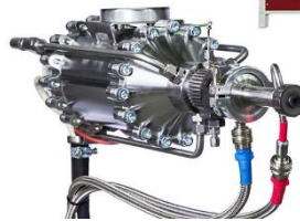
← Pistolet de projection Impact 5/11 refroidit par eau (source: Impact Innovations)
