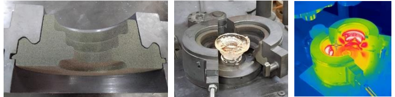
Moule en sable aggloméré, puis suite à la mise en forme et thermographie
