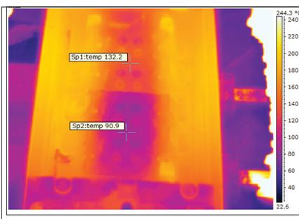
L'insert strato-conçu fini, image thermique des température mesurées (Sp2 : insert Strato) (images projet FUI PROMAPAL)
