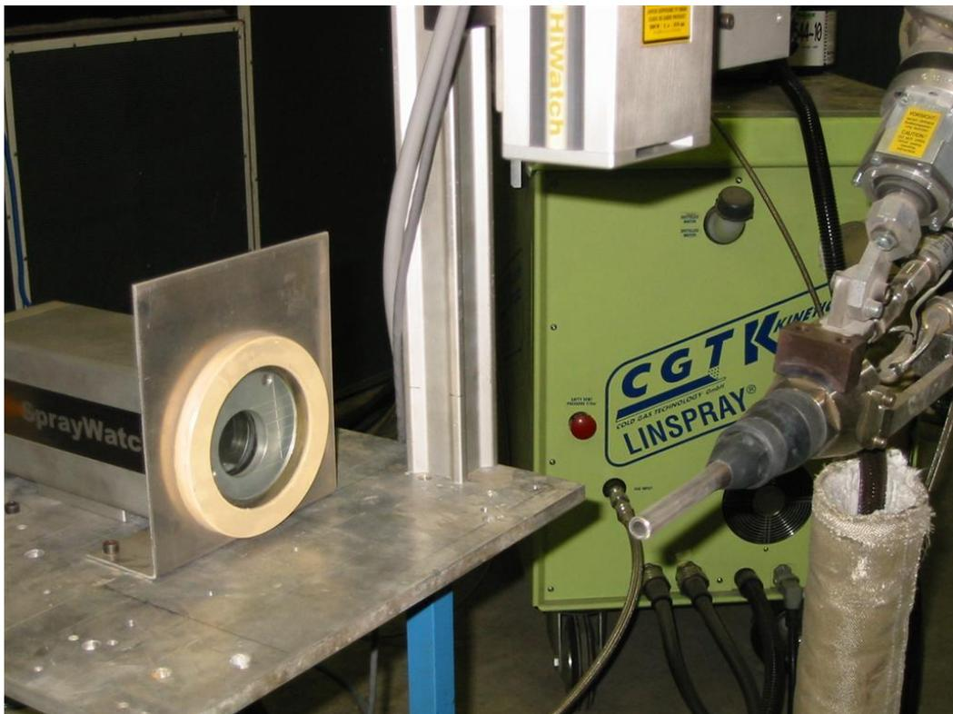
Montage permettant la mesure (SprayWatch & système P.D.F.)
