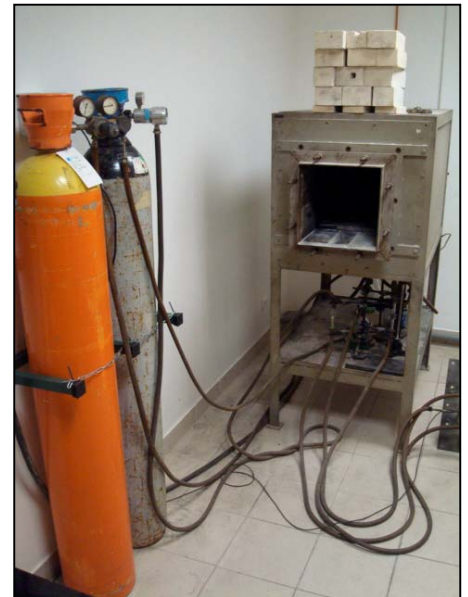
Four pour l'essai de tenue au monoxyde de carbone
