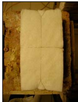
Le croisillon de mesure, constitué du fil chaud et du thermocouple soudé dessus en son milieu. Les branches du thermocouple doivent former un angle droit avec le fil chaud.
