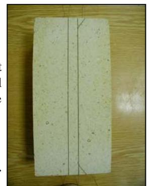
Dans ce cas là, le thermocouple est placé à une distance spécifiée du fil chaud, les branches du thermocouple étant parallèles au fil.
