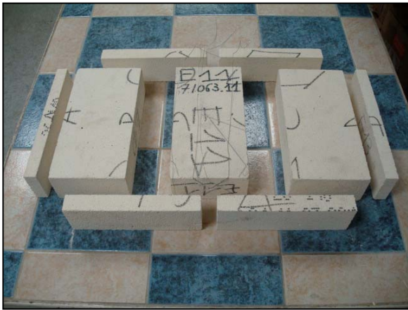
Constitution d'un panneau échantillon ASTM C201
