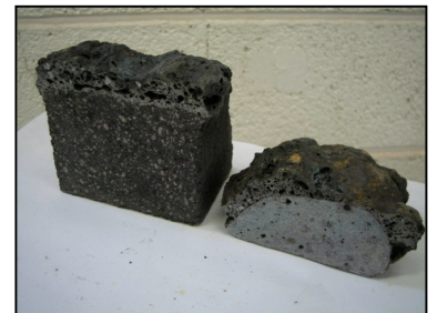
1/2 secteurs de bétons aux comportements différents face à du laitier de fonte
