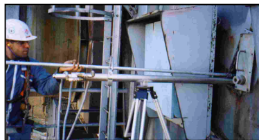
Introduction de l'endoscope dans le four
