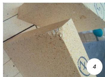
Photo 1 : Echantillonnage pour contrôle par mesures – Photo 2, 3, 4 : Contrôle par attributs : fissure, tache de cuisson et défaut de coin.
