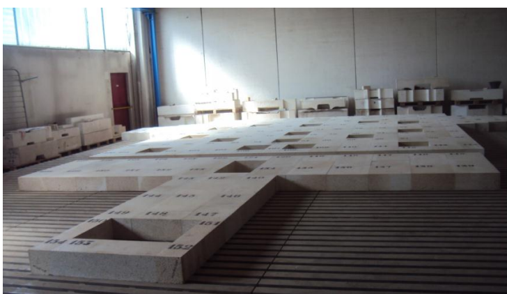
Montage à blanc : sole de four en sillimanite pour four verrier de grande capacité (à gauche) - voûte de fluidisation (en haut à droite) - sole constituée de blocs béton pour four à sole tournante (en bas à droite)
