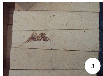
Photo 1 : Echantillonnage pour contrôle par mesures – Photo 2, 3, 4 : Contrôle par attributs : fissure, tache de cuisson et défaut de coin.
