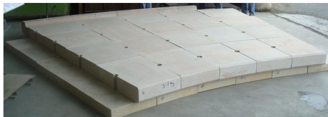
Montage à blanc : sole de four en sillimanite pour four verrier de grande capacité (à gauche) - voûte de fluidisation (en haut à droite) - sole constituée de blocs béton pour four à sole tournante (en bas à droite)
