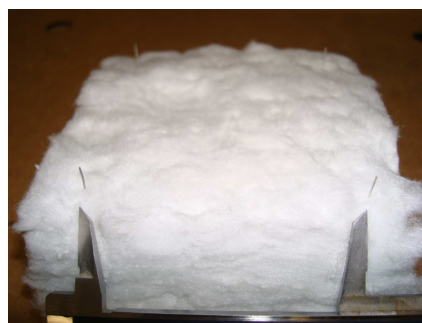
Mesure de la distance entre les repères de platine dans le cas d'un matériau fibreux
