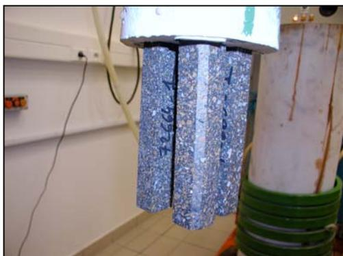
Profil d'usure attendu des éprouvettes après essai (zone de la striction correspondant au point triple) ▼
