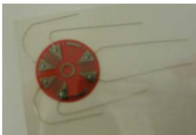
Rosette extensométrique de perçage 3 jauges uniaxiales configuration 0°/45°/90°
