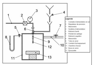
Des éprouvettes de **100 mm** × **100 mm** × **25 mm** peuvent être utilisées pour les matériaux les plus résistants à l'abrasion.
