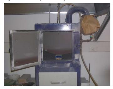
La présente méthode consiste à soumettre la surface plane d'une éprouvette perpendiculairement à une buse projetant 1000 g de grains de carbure de silicium tamisé\* dans un jet d'air comprimé à 450 kPa. L'essai réalisé, la mesure du volume de matériau abrasé (par pesée avant et après essai et mesure de la masse volumique) est une indication de la résistance à l'abrasion du matériau étudié.
