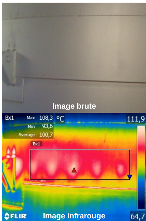
Vue d'une zone garnie avec des pièces sommier posées sur une reprise de charge métallique maintenue au casing par des goussets métalliques soudés
