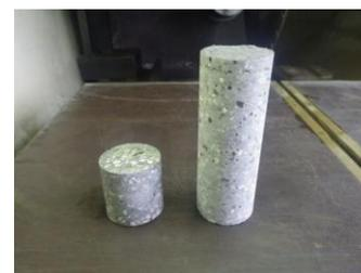
[4] Sciage de la carotte pour réduire la hauteur à 50±Δ mm
