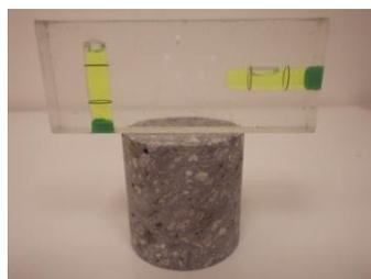
[5] Mesure du parallélisme des faces supérieure et inférieure : ici le parallélisme est mauvais
