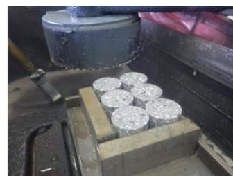
[6] Rectification des faces à l'aide d'une meule plane abrasive
